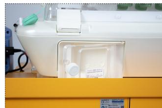
Filterwechsel leicht gemacht - auf der Rückseite des Transportinkubators einfach zugänglich
