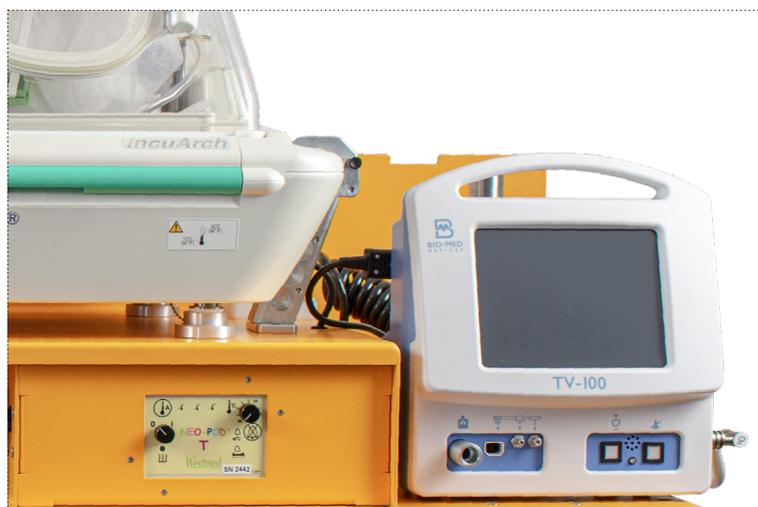
Notfall- und Transportbeatmungsgerät mit Turbine TV-100
