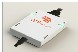
Verstärker in Forschungsqualität EEG-Verstärker in Forschungsqualität mit hoher Eingangsimpedanz für die beste Signalqualität.
