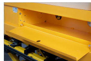
Stauraum für Material was auf dem Transport benötigt wird. Es kann auch eine zusätzliche Gasflasche gelagert werden
