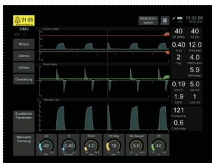
Anzeige von drei Kurven bei der SIMV-Beatmung
